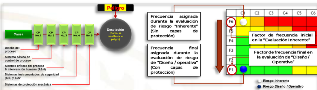
Figura 20; Ejemplo para el reposicionamiento que se realice para los escenarios de riesgo identificados en un ARP, con el objeto de determinar el Riesgo de Diseño/Operativo de una “Capa de protección preventiva”
